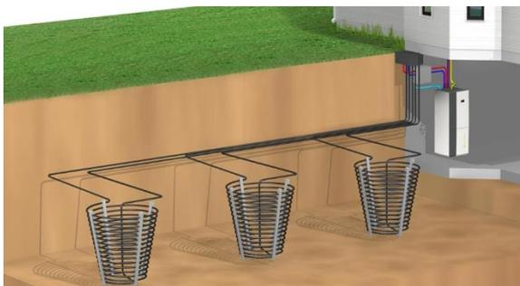
**Abbildung 0-4 Schematische Darstellung zu Erdwärmekörben (Quelle: Noventec GmbH)**
