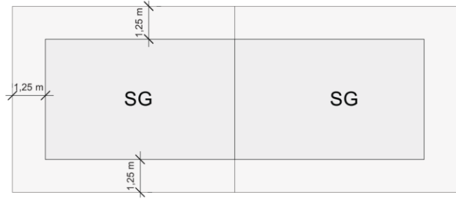
Staffelgeschoss beim Doppelhaus; Quelle: BBP Kaiserslautern / Mannheim
